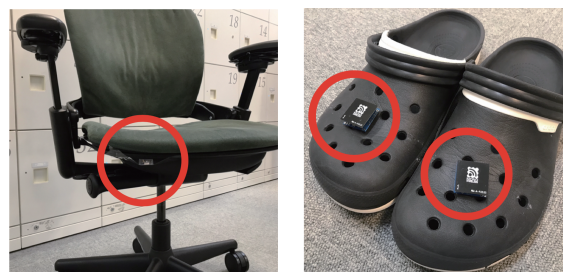
Fig. 1 加速度センサの取り付け位置
