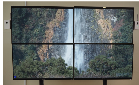
Fig.1 実験に用いるディスプレイ4枚を用いた擬似窓
