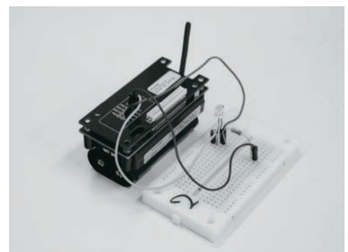
●照度センサを搭載した無線センサノード
