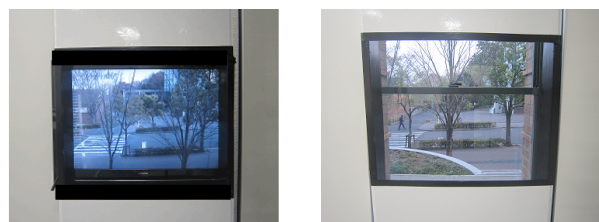
図10 本実験で使用した疑似窓（左）と実際の窓（右）
