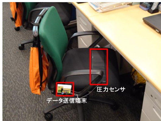
図6. 着座センサの設置状況
